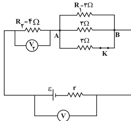
$$\text{کلید باز} \Rightarrow R_{eq} = 4 + \frac{3}{2} = 5.5\Omega$$
